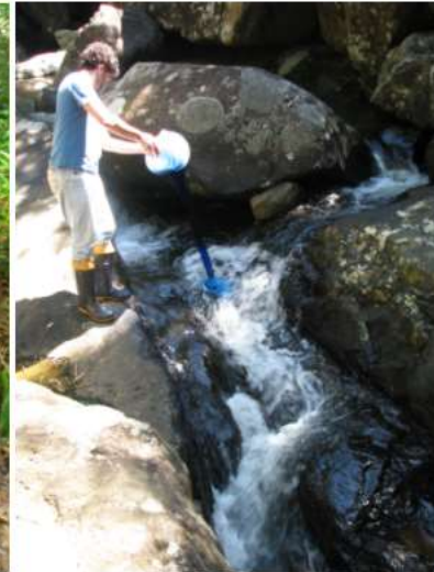
Medição de vazão na Lagoa do Peri: método volumétrico, flutuador e diluição
